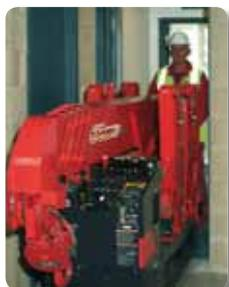
è al comando anche tecnicamente con una serie di innovative funzionalità di sicurezza che includono controllo a computer, sistema intelligente di avviso vocale e l'esclusiva valvola UNIC per la compensazione proporzionale della pressione che consente operazioni di controllo multi funzione del radiocomando.
